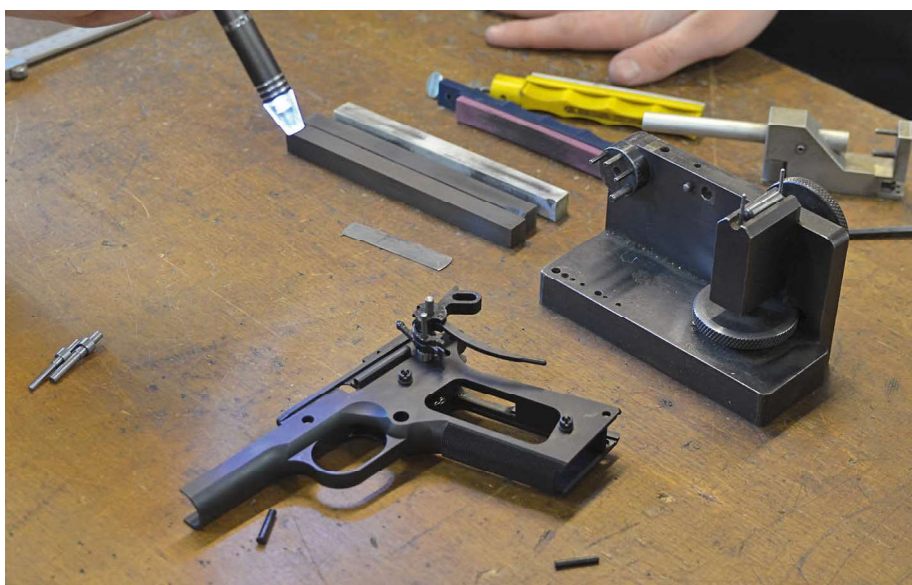
Durch herausstehende Bolzen lässt sich sehr gut die Funktion des Abzugssystems erkennen. Rechts daneben steht ein Abzugsschleifblock, bei dem verschiedene Winkel zur Abzugsüberarbeitung eingestellt werden können.
