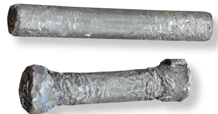
Das „Magic-Tool“ ist ein Bleistab, der bei Smith & Wesson für das Entfernen der Seitenplatte aber auch für kleine Richtarbeiten genutzt wird. Durch das weiche Material hinterlässt es keine bleibenden Spuren an der Waffe. Dem „Magic-Tool“ darunter sieht man seine zwei Jahrzehnte Tätigkeit in Büchsenmacherhand schon deutlich an.
