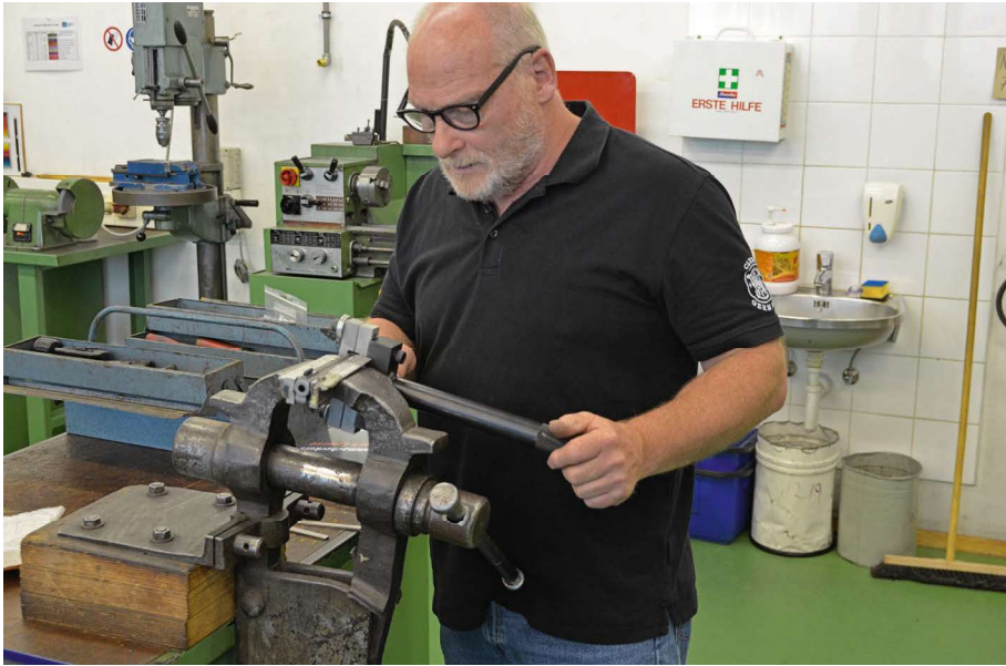
Wenn der Lauf im Rahmen leicht verdreht vom Werk kommt, kann mit Gefühl nachgesetzt werden.
