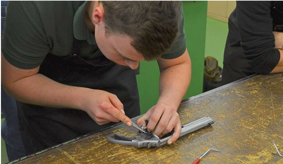
Durch gezielte Feilenstriche am Trommelstern wird das seitliche Trommelspiel eingestellt.
