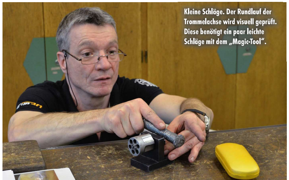
Paul Frauenberg gibt Tipps, wie der Trommelkran mit Hilfe eines Holzkeiles zu richten ist, falls das nötig sein sollte.
