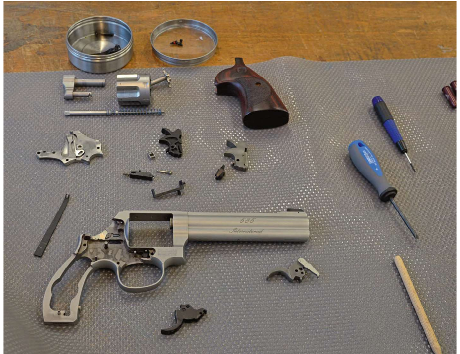
Bevor die Tuningmaßnahmen begannen, wurde der Smith & Wesson 686 in seine Einzelteile zerlegt
