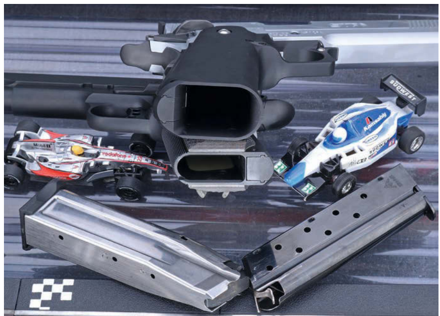
1911er (unten) gegen 2011er Griff: Der größere Magazinschacht beim 2011er Rahmen fällt sofort ins Auge. Schützen müssen bedenken: Auch der Griffumfang steigt.
