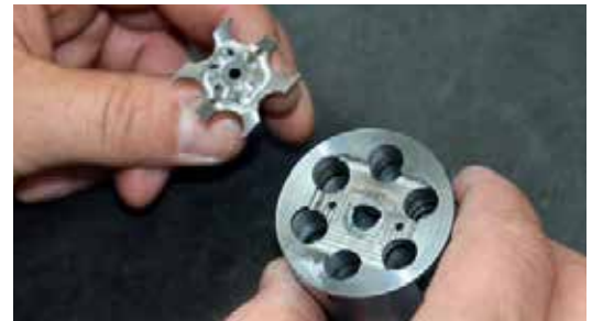
Sorgfalt erfordert das Bohren am Trommelkran zur Aufnahme der zusätzlichen Verriegelung ( double crane lock ). Auch der neue Auswerferstern mit seinen zwecks Torsionssicherung angebrachten Zentrierpins will genau eingepasst sein.
