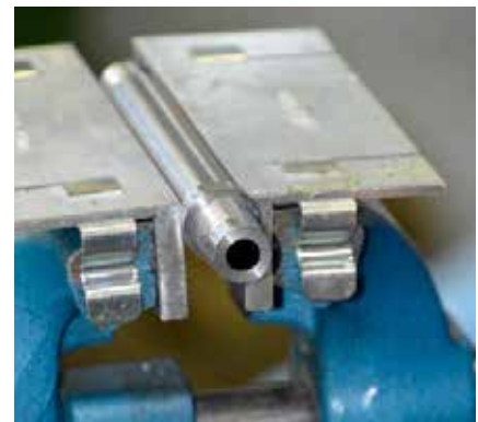
Thorsten Kirsch von der Waffenschmiede Kühn in Offenbach kontrolliert die Passung des Laufs zum Rahmen.
