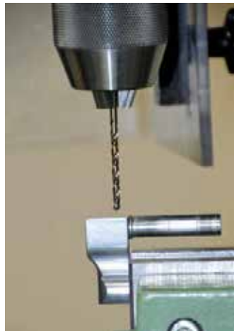
Sorgfalt erfordert das Bohren am Trommelkran zur Aufnahme der zusätzlichen Verriegelung ( double crane lock ). Auch der neue Auswerferstern mit seinen zwecks Torsionssicherung angebrachten Zentrierpins will genau eingepasst sein.
