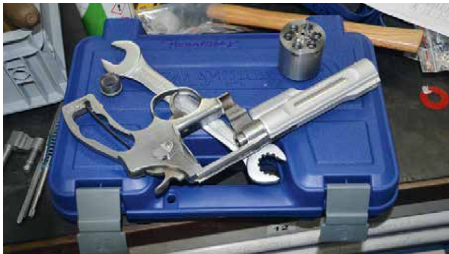
Thorsten Kirsch von der Waffenschmiede Kühn in Offenbach kontrolliert die Passung des Laufs zum Rahmen.
