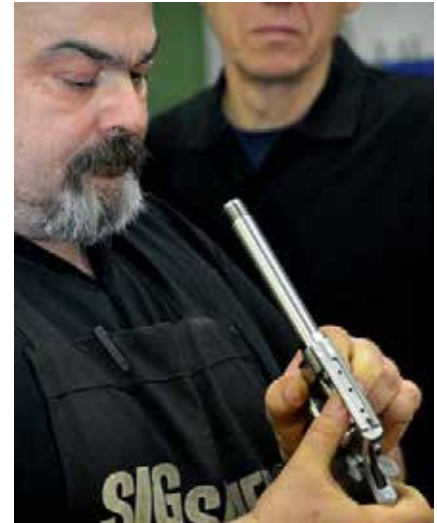
Thorsten Kirsch von der Waffenschmiede Kühn in Offenbach kontrolliert die Passung des Laufs zum Rahmen.
