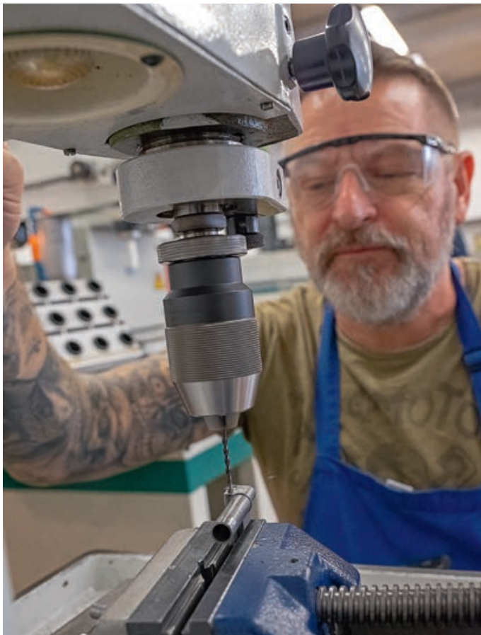
Mit Augenmass und Gefühl: Rolf W. Schaufelberger beim Bohren der Löcher für den Crane Lock, eine Trommelverriegelung basierend auf zwei federgespannten Kugeln.
